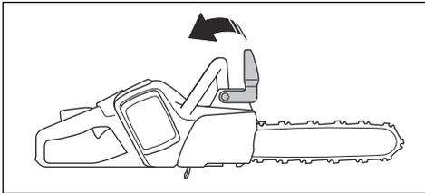
2. Lösen Sie die Schienenmutter und entfernen Sie die Abdeckung des Kettenantriebsrads und den Transportring (A).
