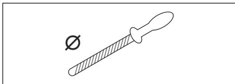
Verige ni enostavno pravilno nabrusiti brez ustrezne opreme. Uporabite priporočeno šablono za brušenje Husqvarna. Tako boste ohranili največjo učinkovitost rezanja in zmanjšali tveganje povratnega udarca.
