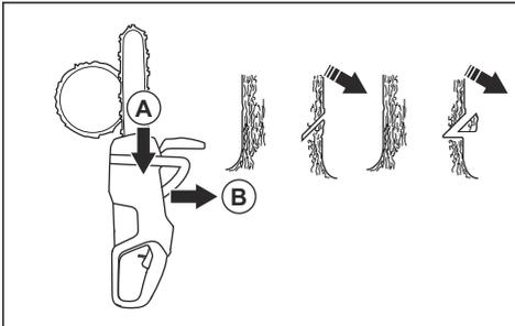
2. Stellen Sie sicher, dass die Kerbschnittlinie genau waagrecht ist und im rechten Winkel (90 °) zur Fallrichtung steht. Die Kerbschnittlinie geht durch den Punkt, wo die beiden Kerbschnitte sich berühren.
