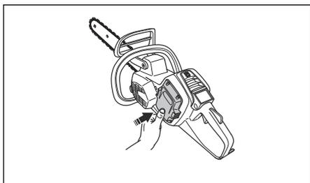
5. Pridržite gumb za vklop/izklop, dokler ne zasveti zeleni indikator LED.
