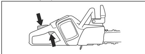
2. Pritisnite zaklep sprožilca plina in se prepričajte, da se vrne v začetni položaj, ko ga sprostite.
