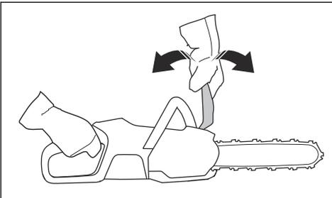
3. Halten Sie das Gerät mit abgeschaltetem Motor über einen Baumstumpf oder einen anderen stabilen Gegenstand.
