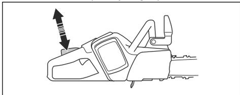
3. Prepričajte se, da je sprožilec plina zaklenjen v položaju prostega teka, ko je zaklep sprožilca plina sproščen.
