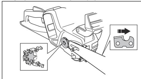
5. Prepričajte se, da so robovi rezalnih členov na zgornjem robu meča obrnjeni naprej.
