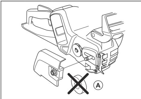
3. Platzieren Sie die Führungsschiene auf dem Schienenbolzen. Bringen Sie die Führungsschiene in ihre hinterste Stellung. Heben Sie die Sägekette über das Kettenantriebsrad, und passen Sie sie in die Nut in der Führungsschiene ein. Beginnen Sie an der Oberkante der Führungsschiene.
