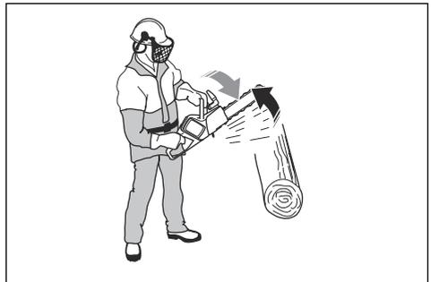
Verwenden Sie die Kettenbremse als Feststellbremse, wenn Sie das Gerät starten und sich über kurze Strecken bewegen. Dadurch reduzieren Sie das Risiko,
