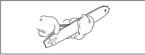
4. Überprüfen Sie die Nut in der Führungsschiene auf Verschleiß. Tauschen Sie die Führungsschiene aus wenn nötig.
