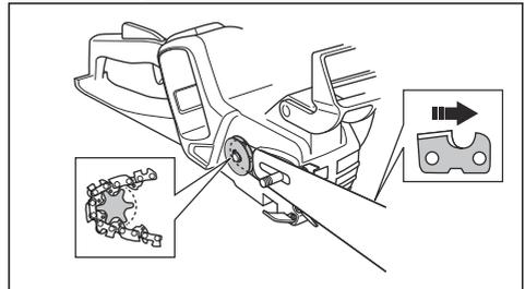
5. Achten Sie darauf, dass die Schneiden der Sägezähne auf der Oberkante der Führungsschiene nach vorn gerichtet sind.
