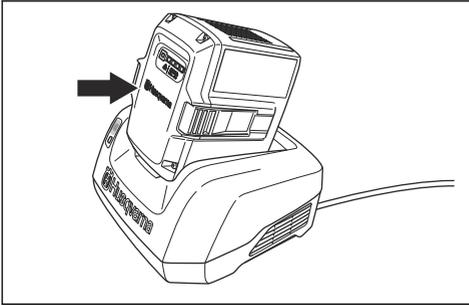
3. Stellen Sie sicher, dass die grüne Ladeanzeige auf dem Ladegerät aufleuchtet. Das bedeutet, dass der Akku richtig mit dem Ladegerät verbunden ist.
