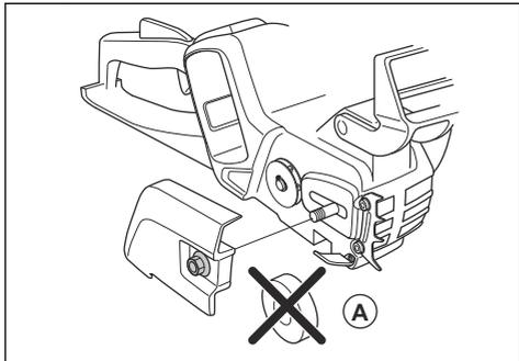
3. Na vijak meča namestite meč. Pomaknite meč v skrajno zadnji položaj. Dvignite verigo nad pogonski zobnik in jo vpnite v utor meča. Začnite na zgornji strani meča.
