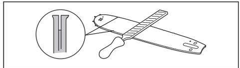
3. Reinigen Sie die Nut in der Führungsschiene.
