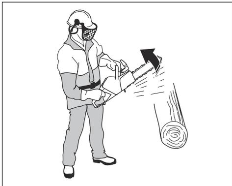
Do povratnega udarca pride samo, če se območje povratnega udarca meča dotakne predmeta. Ne dopustite, da se območje povratnega udarca dotakne predmeta.
