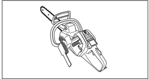
1. Reinigen Sie das Kühlsystem wöchentlich oder bei Bedarf häufiger mit einer Bürste.
