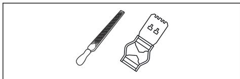
1. Nastavev globine reza prilagodite s ploščato pilo in šablono za brušenje globinskih zob. Uporabljajte samo šablono za brušenje globinskih zob za nastavev ustrezne globine in šablono za brušenje zelenih rezalnih zob družbe Husqvarna.
